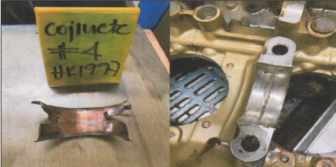
Fotografía No. 6: Cojinete del punto de apoyo # 4
