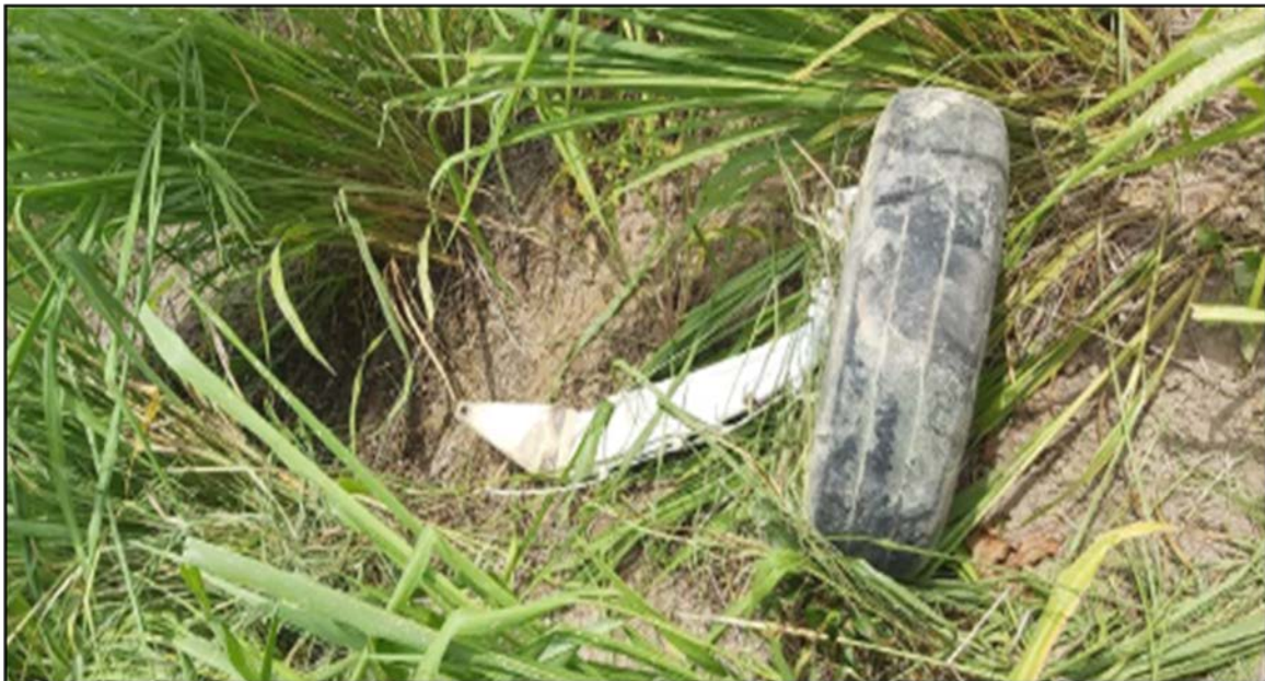
Fotografía No. 4: Desprendimiento tren principal izquierdo HK1997
